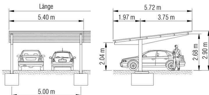
Der Autounterstand GM zeichnet sich durch sein offenes Erscheinungsbild aus. Die stabilen Ausleger tragen das Dach ohne zusätzlich vorne liegende Stützen und ermöglichen somit optimale Befahrbarkeit. Im Gegensatz zum ähnlichen Unterstand GEB werden durch die etwas nach vorne versetzten Stützen kleinere Fundamente benötigt. Diverse Optionen wie bspw. Wände oder Bedachungen in verschiedenen Materialien ermöglichen eine individuelle Gestaltung und bieten zusätzlichen Schutz und Sicherheit.
