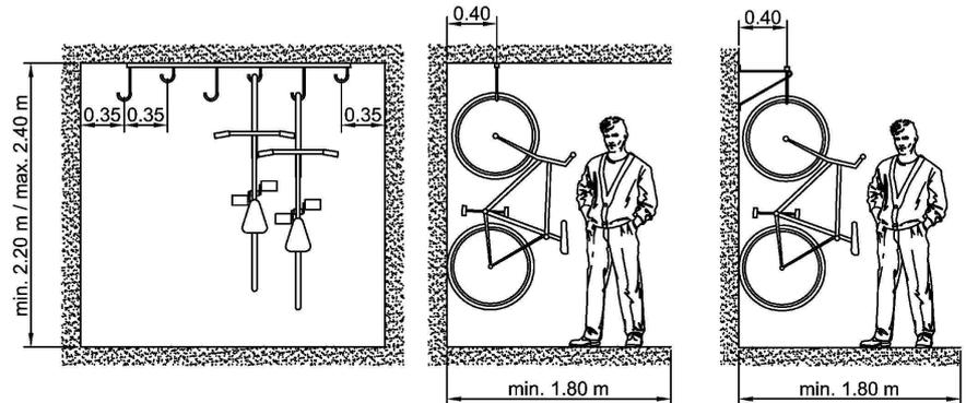
Aufhängungen werden dann eingesetzt, wenn engste Platzverhältnisse wie in Garagen oder Kellerräumen vorherrschen. Die höhenversetzten und mit Felgenschutz versehenen Haken bieten einer maximalen Anzahl an Fahrrädern sicheren Halt. Die Aufhängungen können problemlos in Eigenmontage an Decken (Typ A) oder an Wände (Typ AK) montiert werden. Befestigungsmaterial wird mitgeliefert.
